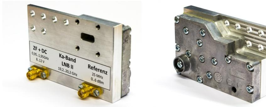
**Abb. 6.5:** Modifiziertes Ka-Band LNB-Modul des Herstellers *Global Invacom* [131]
