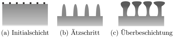
Abbildung 5.5: Darstellung der Prozessschritte zur Erzeugung von nanostrukturierten Polymeroberflächen mit Initialschicht und Überbeschichtung.
