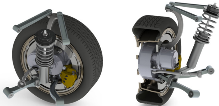
Abb. 7-18: Mehrlenker-Radaufhängung für Radnabenantrieb mit desachsiertem Getriebe
