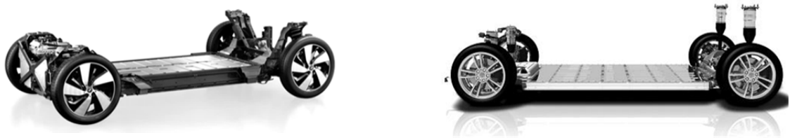
Abb. 2-30: Skateboard-Design für Fahrzeugaufbauten mit elektrischen Antriebssträngen 109
