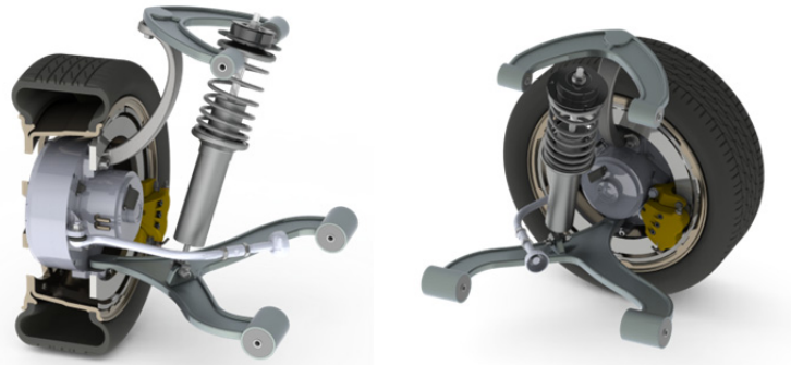
Abb. 7-19: Doppelquerlenker-Radaufhängung für Radnabenantrieb mit coaxialem Getriebe
