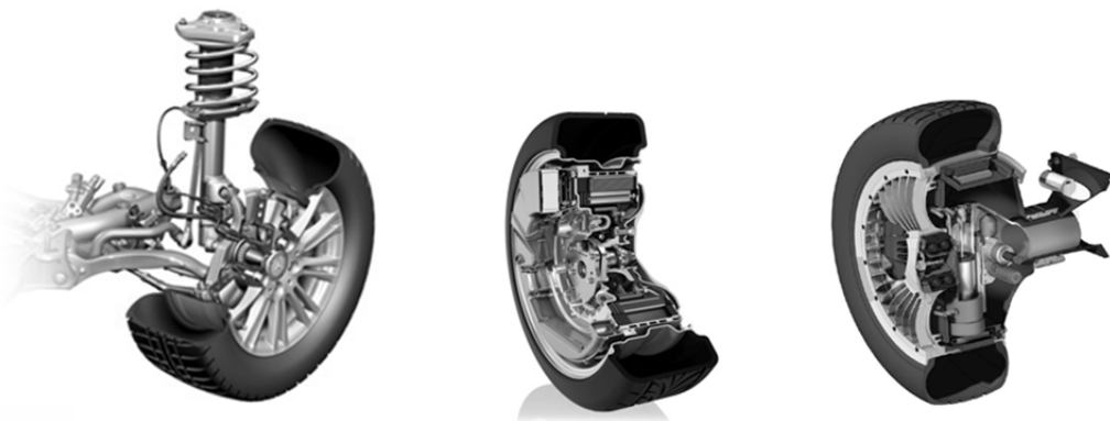
Abb. 1-3: Beispiel für die Entwicklung von konventionellen Radaufhängungen 4 (li.) zu elektrischen Radnabenantrieben 5 (mi.) und aktiven Corner-Modulen 6 (re.)
