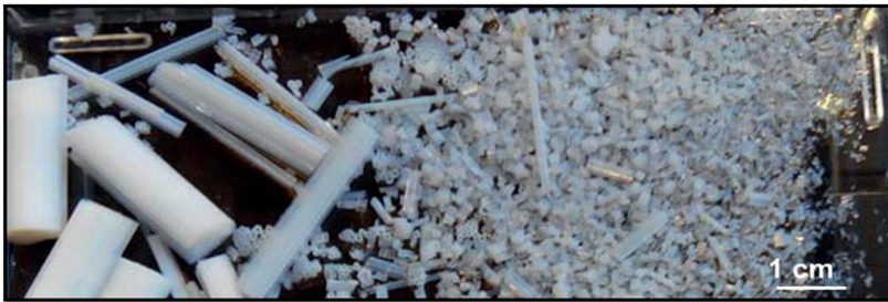
Abb. 63: Glasbündel nach der Extraktion, Extraktion mit milden Bedingungen (intakte Bündel, links) und mit aggressiven Bedingungen s. 3.1.3 (Glasbruch, rechts).
