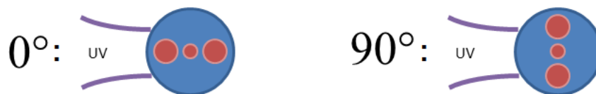
Abbildung 5.3: Verwendete Ausrichtungen der Panda-Faser beim Einschreiben. 0^\circ entspricht einer UV-Belichtung parallel zur Slow-Achse, 90^\circ bedeutet eine UV-Belichtung senkrecht zur Slow-Achse.
