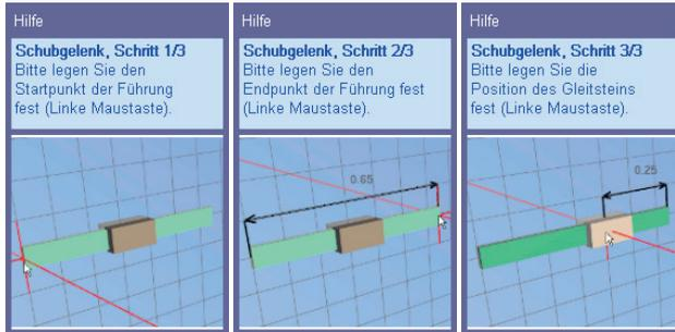
Abbildung 4.30: Dokumentation des Interaktionszustandes für den Interaktor zur Erzeugung von Schubgelenken
