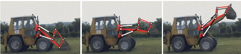
Abbildung 6.29: Überlagerung von Realvideo mit nachmodelliertem technischen Prinzip
