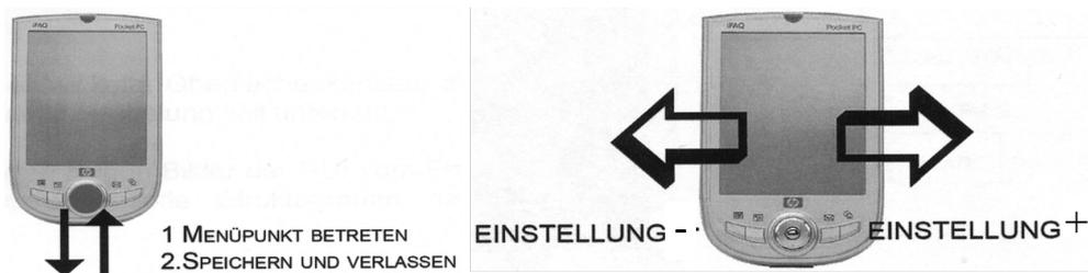
**Abbildung 6-34:** Veranschaulichung der Bedienung des TAS-Endgeräts zur Änderung einer Einstellung (z. B. lauter/leiser)
