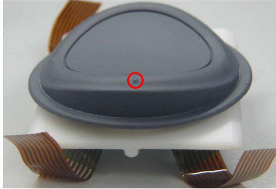
**Abbildung 6-20:** Berührungsempfindliches Bedienelement der FB2002 (Lutherdt u.a. 2003, S. 79), gekennzeichnet ist die haptisch fühlbare vordere Quadrantenmarke
