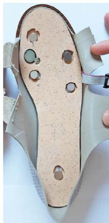
**Abbildung 3-11:** Die aus der Verteilung der Rezeptoren in der Fußsohle abgeleitete Anordnung von Vibrationsaktoren in einer Schuhsohle als Informationsschnittstelle (aus Lutherdt, Roß & Witte 2016)
