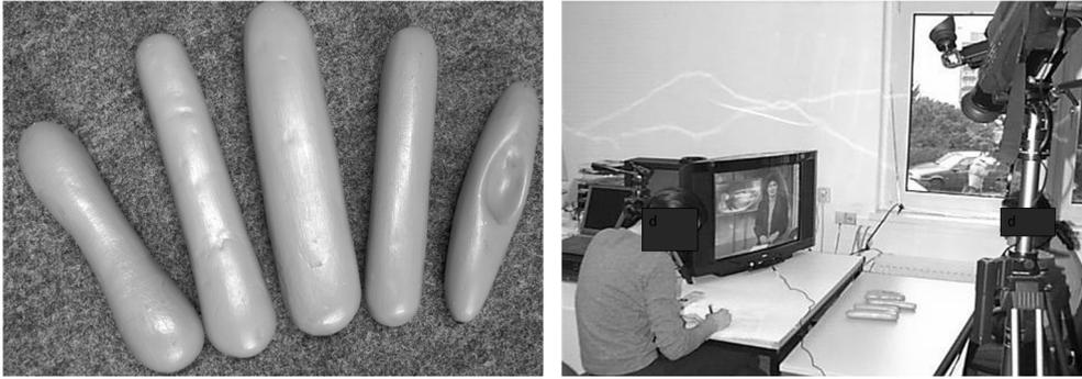
**Abbildung 6-13:** Für die Probandentests genutzte Gips-Formmodelle (links, diese wurden mit Papier-mock-ups für die Repräsentation der Eingabelemente versehen); Durchführung der Nutzertests mit den Formmodellen an einem realen TV-Gerät mit Videoprotokollierung (rechts)
