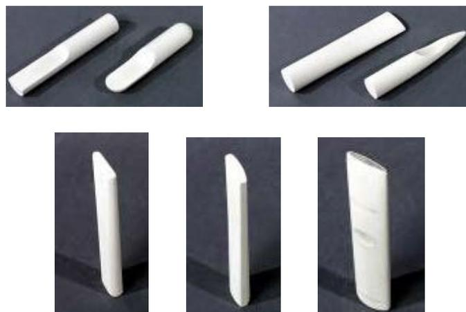
**Abbildung 6-17:** Formmodelle aus Modell-Hartschaum zur Erarbeitung der Grundform der neuartigen FB nach den Vorgaben des Anforderungskatalogs (aus Lutherdt u.a. 2003, S. 82)
