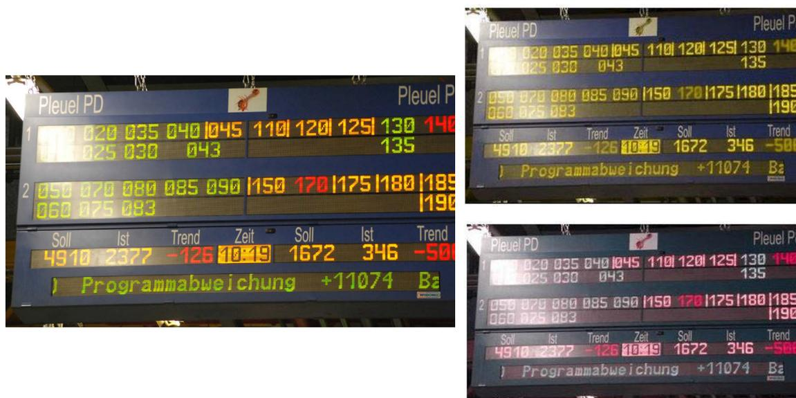
**Abbildung 7-7:** Simulierter Seheindruck der Anzeigen eines Andon-Boards für einen Farbfehlsichtigen mit deutlich erkennbarem Informationsverlust (rechts oben deuteranop, rechts unten tritanop)
