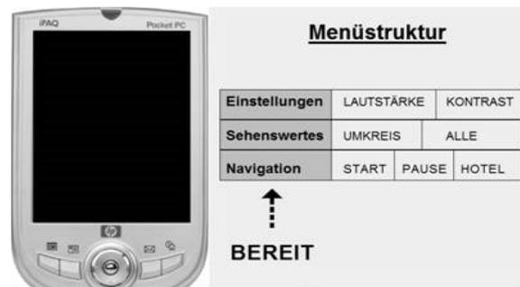
**Abbildung 6-35:** Erläuterung der Menüstruktur des TAS-Endgeräts (3 + 2 bzw. 1 + 3 Struktur der Menüpunkte und Auswahlmöglichkeit / Untermenüs)
