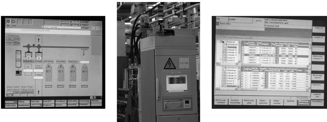
**Abbildung 7-2:** Informations- und Bedienschnittstellen direkt an und auf den Bearbeitungszentren (eigene Aufnahmen 2009)
