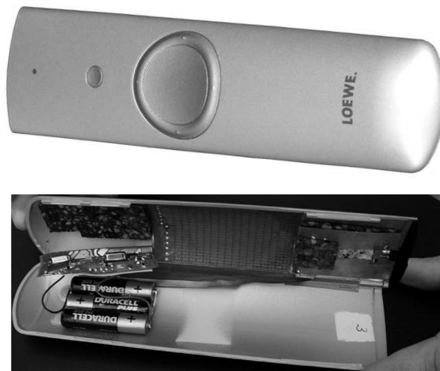
**Abbildung 6-19:** Abschließender, resultierender Designentwurf (oben) und Elektronikkomponenten in Innern des Funktionsmusters zum Einsatz in Nutzertests (unten)
