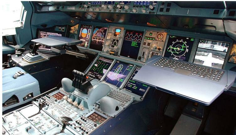
**Abbildung 2-7:** Beispiel für die Vielfalt und Kombinationsmöglichkeiten verschiedenster Ein- und Ausgabegeräte in einem aktuellen Flugzeugcockpit (Airbus A380 [airwaysnews.com])
