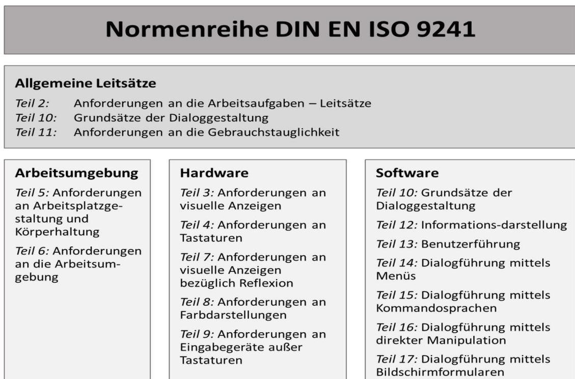
**Abbildung 5-9:** Auswahl einiger Normen der Reihe ISO 9241 zur Verdeutlichung des Aufbaus der Reihe und der damit abgedeckten Gestaltungsfelder
