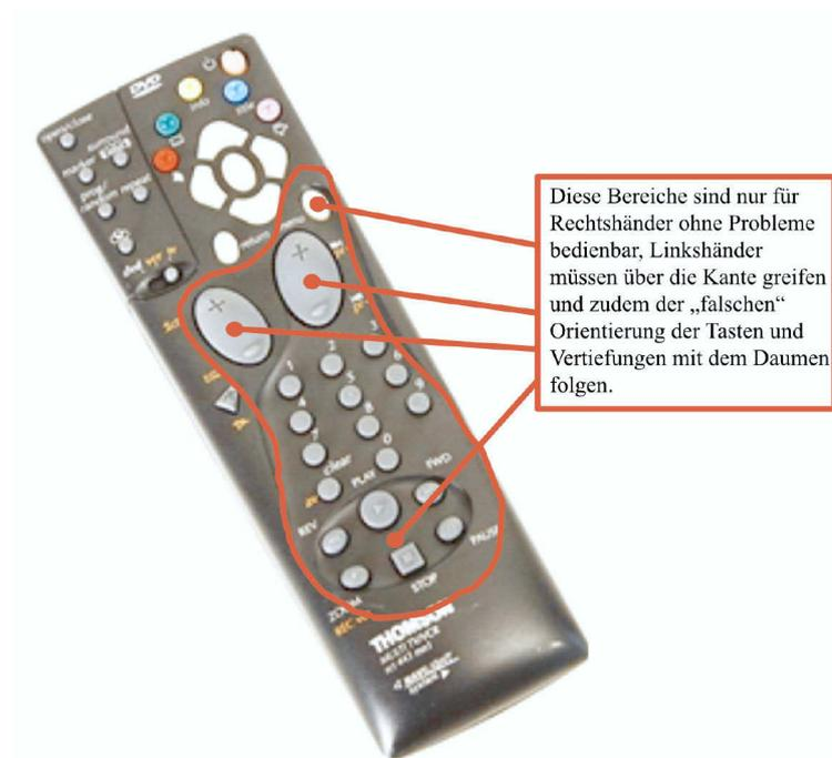
**Abbildung 3-16:** „Anatomisch“ vorgeformte Fernbedienung der Fa. Thomson (2000) mit deutlicher Einschränkung der Nutzbarkeit für Linkshänder (Bildquelle [amazon.de])
