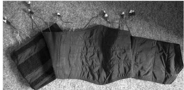
**Abbildung 7-18:** Vibro-Gurt mit 20 Motoren und elektrischen Anschlüssen (eigene Aufnahmen)
