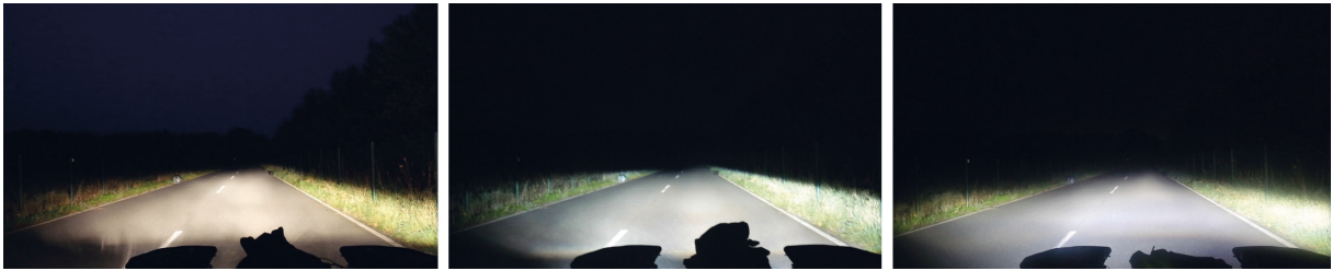
Abbildung 2.4: Vergleich der Audi A6 (C7) Serienscheinwerfer hinsichtlich der unterschiedlichen ähnlichsten Farbtemperaturen (Links: Halogen; Mitte: Xenon; Rechts: LED)
