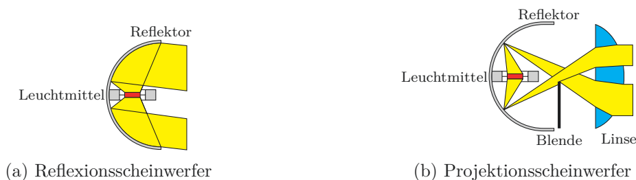
Abbildung 2.1: Schematischer Aufbau eines Reflexions- (links) und Projektionssystems (rechts) in Seitenansicht [Pet14]
