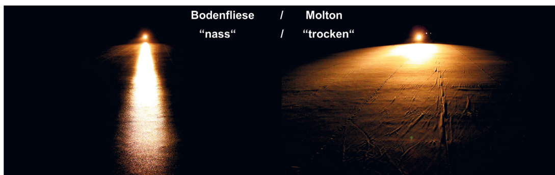
Abbildung 5.18: Erscheinungsbild der „Blendkeulen“ bei geänderten Reflexionseigenschaften der Fahrbahndeckschicht (li. Bodenfliese, re. Molton) (vgl. [BMK + 13])
