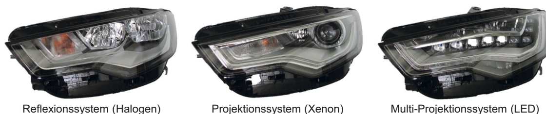
Abbildung 2.2: Vergleich der optischen Systeme des Audi A6 (C7) Serienscheinwerfers
