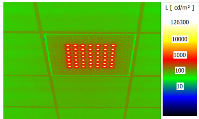
Abb. 3.18 Leuchtdichtebild in Falschfarbendarstellung der Blendquelle. Darin ist auch die ungleichmäßige Leuchtdichteverteilung der Einzel-LEDs erkennbar.
