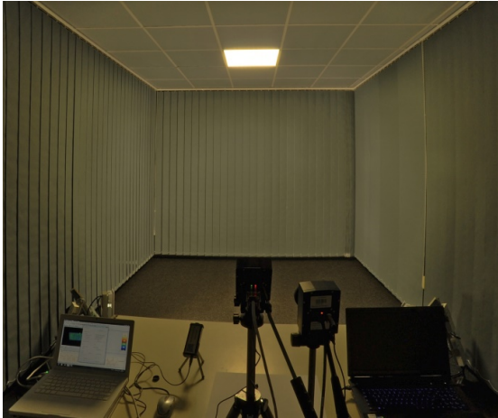
Abb. 3.13 Messaufbau zur lichttechnischen Vermessung des Untersuchungsraums [Mei 14, S. 31]
