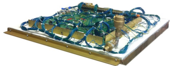
Abb. 3.7 Foto der Leuchte mit Steuerungselektronik und Anschluss an den Wasserkreislauf [Mei 14, S. 29] (Bildbearbeitung: INGO HERZOG)
