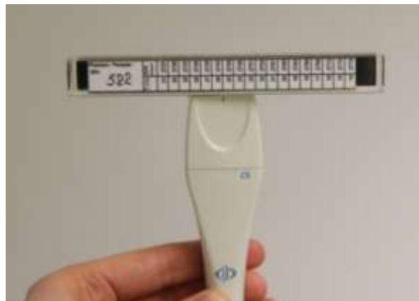
Abbildung 5: Qualitätsprüfung mittels Phantommessung (Phantom Perspex, Seriennummer 522)
