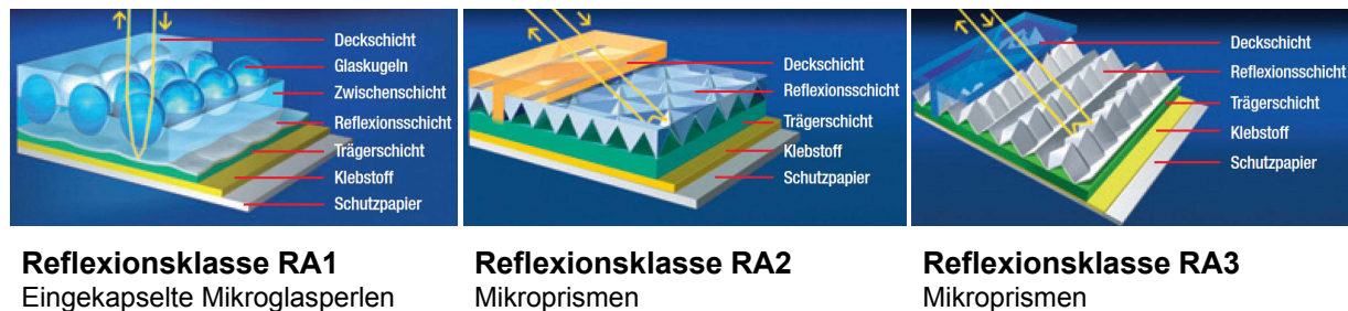
Abbildung 2.3: Schematischer Aufbau unterschiedlicher retroreflektierender Materialien für den Einsatz im Straßenverkehr [3M 07]
