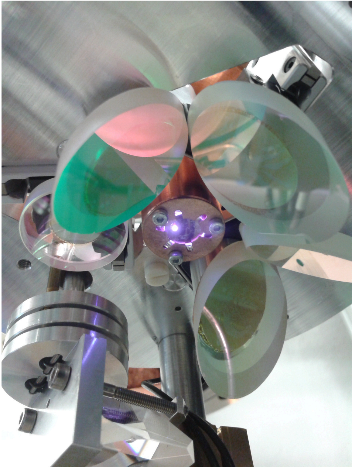
Abbildung 3.2: Blick in den Laseraufbau: gepumpte Scheibe und Pumpoptiken. Die ovalen Spiegel bilden paarweise je eine Umlenkeinheit. Die violette Fluoreszenz ist vermutlich eine Materialverunreinigung.
