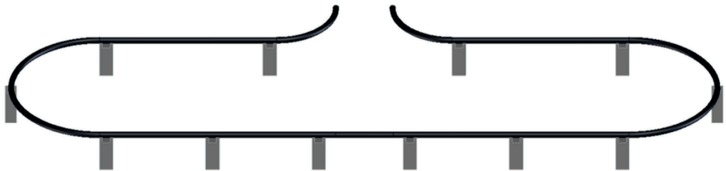
Abbildung 3-8: Prüfaufbau zur Messung der Temperatur an einer Leitung
