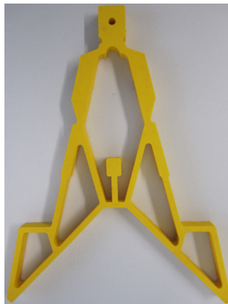
Abb. 8: Nachgiebiger Greifer ohne Sensorelemente aus [8]
