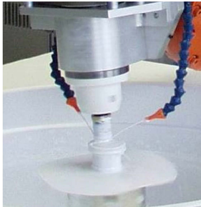
Abbildung 21: Politur einer rotationssymmetrischen Oberfläche; der graue Polierkopf im oberen Teil des Bildes drückt das sich drehende Werkzeug auf das sich ebenso drehende Werkstück. Das Poliermittel wird über die blauen Schläuche direkt auf das Werkstück zugeführt. Die Folie unterhalb dient dem Spritzschutz.
