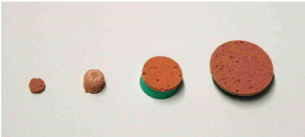
Abbildung 25: Auswahl an Werkzeugen zur Padpolitur; von links: 6mm Pad, Kugelwerkzeug mit Radius 4mm, 16mm Pad mit Elstomer, 26mm Pad
