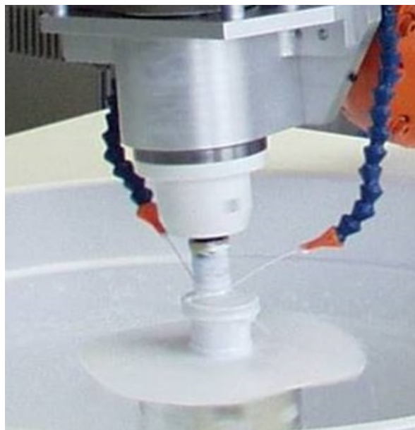
Abbildung 7 Subaperturpolitur einer Glaslinse
