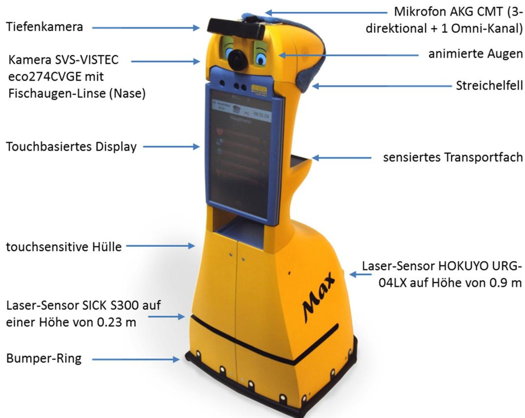
Abb. 7: Roboterplattform MetraLabs SCITOS G3 (Gross et al., 2011; Gross et al., 2012)
