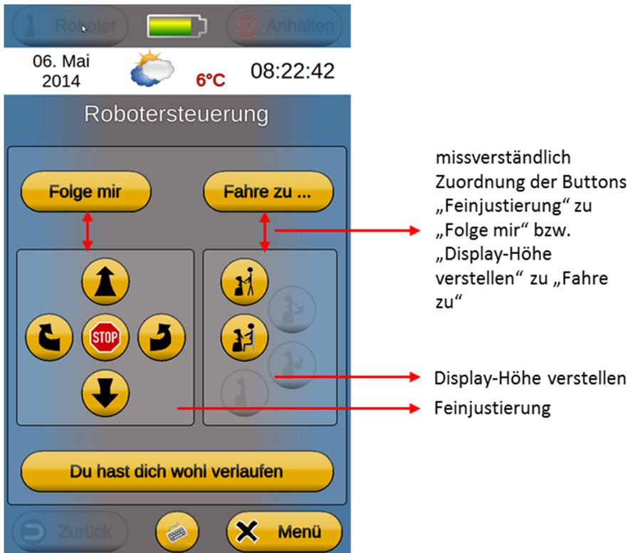
Abb. 19: Screenshot des GUI-Dialogs "Robotersteuerung" (kommentiert)
