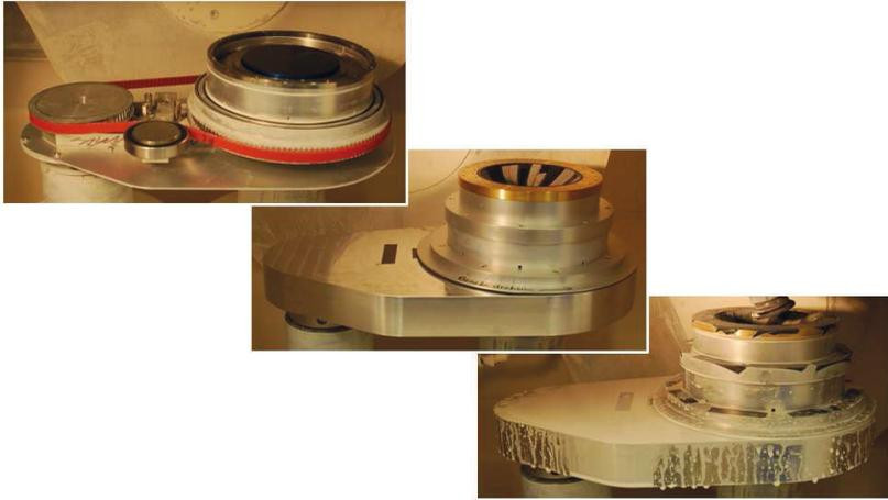
Abb. 31: Schrittweiser Aufbau und Inbetriebnahme des vollaperturigen, aktiv-adaptiven Polierwerkzeugs
