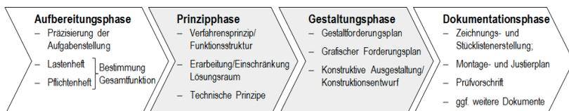
Abb. 10: Phasen und dazugehörige Inhalte des Konstruktiven Entwicklungsprozesses nach [Leh03]
