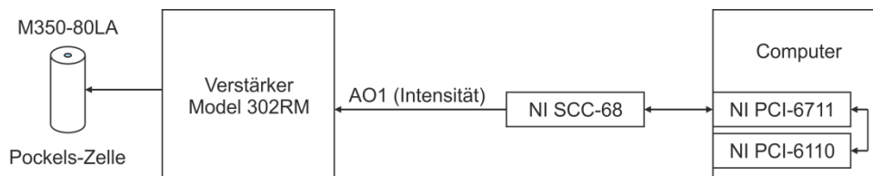
Abbildung 3.6: Ansteuerung der Pockels-Zelle. Das Hochgeschwindigkeits-Analogausgangsmodule NI PCI-6711 wandelt die Steuerspannung "AO1 (Intensität)" digital-analog und stellt diese über den 68-Pin-Anschlussblock NI SCC-68 dem Verstärker der Pockels-Zelle bereit. Der Verstärker erzeugt in Abhängigkeit von der Steuerspannung eine Hochspannung, die eine Modulation der Anregungsintensität in der Pockels-Zelle ermöglicht.
