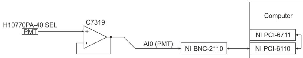
Abbildung 3.3: Signalkette des Detektorsignals. PMT – Photomultiplier. C7319 – Vorverstärker des vom PMT detektierten Intensitätssignals. "AI0 (PMT)" – verstärkter Signaleingang in den geschirmten Anschlussblock NI BNC-2110. Das Analogsignal wird im Multifunktions-Datenerfassungsmodul NI PCI-6110 analog-digital gewandelt.
