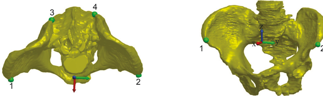
Abb. B2: Darstellung des CAD-Modells der Hüfte mit definiertem Koordinatensystem
