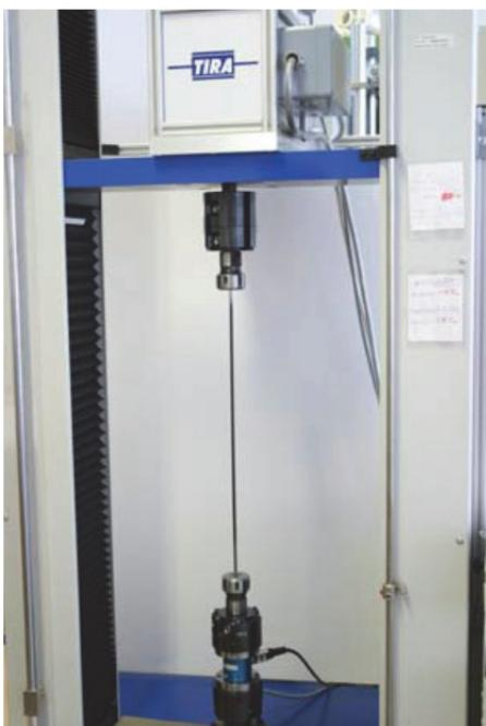
**Abbildung 6.3:** Torsionsprüfmaschine Typ Tira
