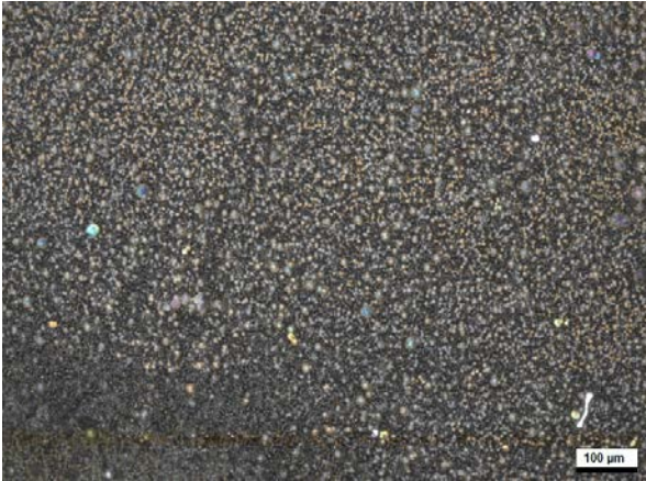
Abb. 58: Auflichtmikroskopaufnahme Glanznickel E_R (40 min), SPK (0,2 mV/s) bis E = 646 \text{ mV}_{(\text{NHE})} 6 M \text{CaCl}_2 , Oberfläche: G Ni mit Deckschicht [25]
