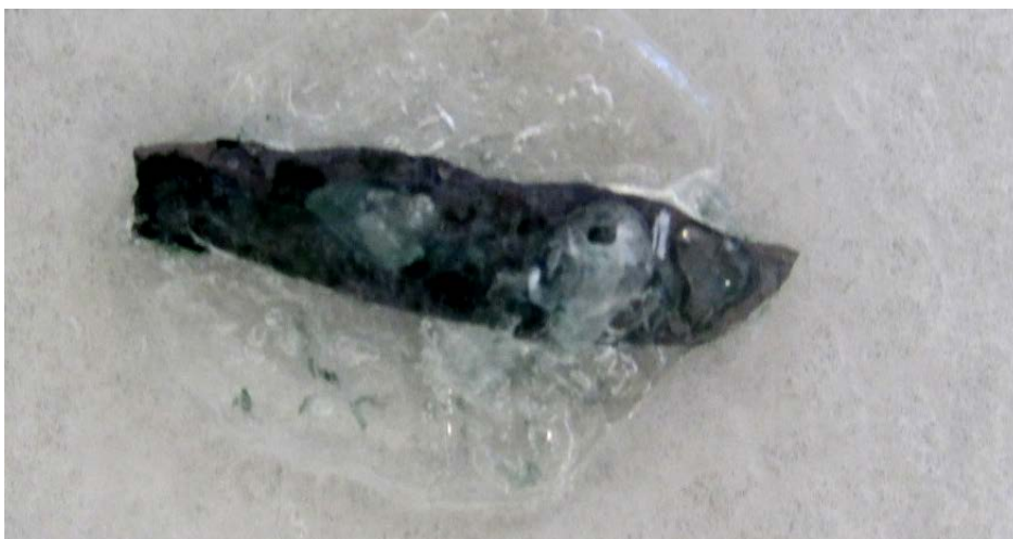
Abb. 88: Galvanisch abgeschiedenes reines Chrom unter \text{CaCl}_2 Belastung im Exsikkator [ m_o = 10,00 \text{ g} , c_o = 1 \text{ M} , \vartheta = 23,5 \pm 1,5 \text{ }^\circ\text{C} , \varphi = 15 \pm 0,5 \text{ \% r. F.} ]
