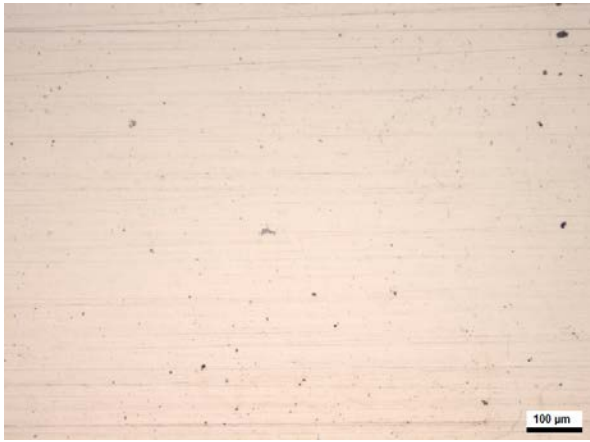
Abb. 83: Auflichtmikroskopaufnahme SnNi (A) nach E_R (40 min) und SPK (0,2 mV/s) bis E = 646 \text{ mV}_{(\text{NHE})} 6 M \text{CaCl}_2 , Oberfläche: SnNi (A) [25]
