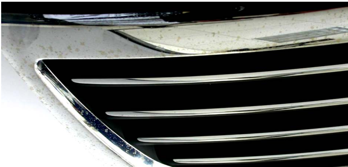
Abb. 1: Verchromtes Kühlerschutzgitter, Kühlergrill (mikroporig), Mittellamellen (mikrorissig), sichtbarer Chromschaden des mikroporigen Kühlergrills mit großflächiger Freilegung von Nickel in Form von gelblichen Korrosionsstellen über die gesamte Fläche, Mittellamellen mikrorissig i.O.
