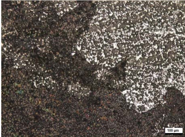
Abb. 61: Auflichtmikroskopaufnahme Glanznickel E_R (40 min), SPK (0,2 mV/s) bis E = 706 \text{ mV}_{(\text{NHE})} 5 M \text{MgCl}_2 , Oberfläche: HG Ni/G Ni [25]
