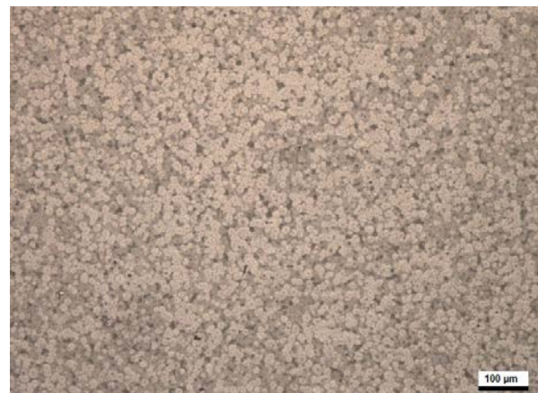
Abb. 60: Auflichtmikroskopaufnahme NiP 15 % E_R (40 min), SPK (0,2 mV/s) bis E = 646 \text{ mV}_{(\text{NHE})} 6 M \text{CaCl}_2 , Oberfläche: NiP 15 % [25]
