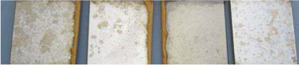
Abb. 101: Bauteilproben nach MgCl_2 Belastung und Reinigung mit einem nassen Mikrofasertuch und Spülmittel
