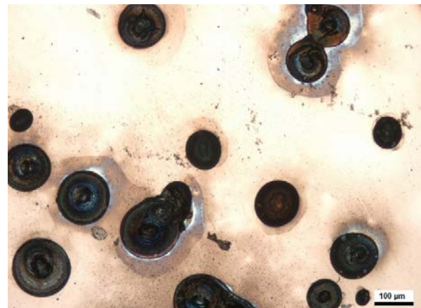
Abb. 82: Auflichtmikroskopaufnahme SnNi (B) nach E_R (40 min) und SPK (0,2 mV/s) bis E = 567 \text{ mV}_{(\text{NHE})} 4 M NaCl, Oberfläche: SnNi (B) mit Poren bis Cu [25]
