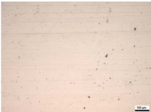
Abb. 81: Auflichtmikroskopaufnahme SnNi (A) nach E_R (40 min) und SPK (0,2 mV/s) bis E = 567 \text{ mV}_{(\text{NHE})} 4 M NaCl, Oberfläche: SnNi (A) [25]
