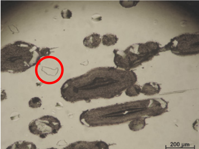
Abb. 36: Auflichtmikroskopaufnahme mikroporiges Bauteil nach Polarisationsmessung, 3 mV/ s in 6 M CaCl 2 , pH 6, 1h, A= 1,53 cm 2 , i= 65,4 µA/ cm 2 , ○ = mechanisch abgebrochenes Stück Chrom
