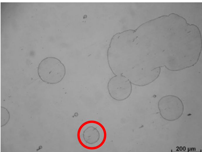
Abb. 37: Auflichtmikroskopaufnahme mikroporiges Bauteil im Originalzustand nach galvanostatischem Halteversuch in 6 M CaCl 2 , pH 6, 1h, A= 1,53 cm 2 , i= 65,4 µA/ cm 2 , ○ = Chrom korrodiert mit darunter freigelegtem Nickel
