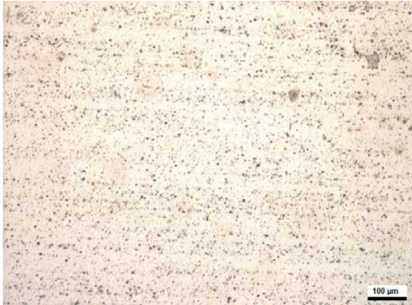
Abb. 74: Auflichtmikroskopaufnahme NiW 29,5 % nach E_R (40 min) und SPK (0,2 mV/s) bis E = 706 \text{ mV}_{(\text{NHE})} 5 M \text{MgCl}_2 , Oberfläche: NiW 29,5 % [25]
