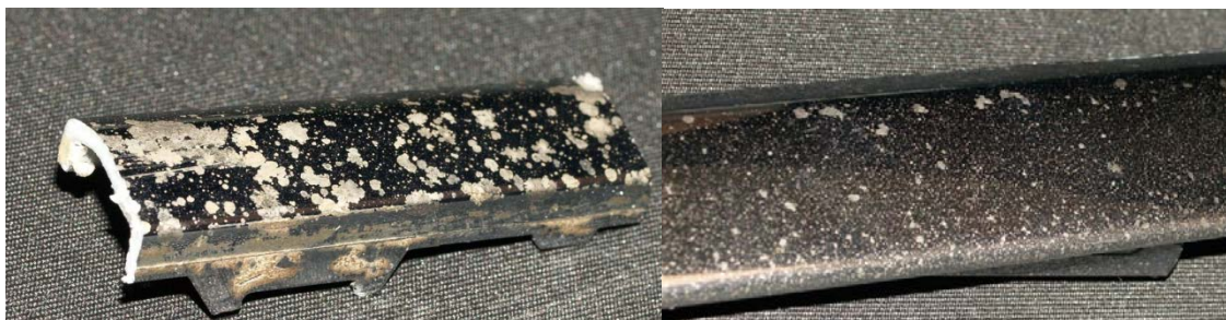
Abb. 110: Feldschadenteile mit Chromkorrosion
