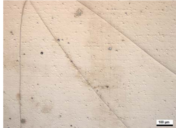
Abb. 75: Auflichtmikroskopaufnahme NiW 36 % nach E_R (40 min) und SPK (0,2 mV/s) bis E = 706 \text{ mV}_{(\text{NHE})} 5 M \text{MgCl}_2 , Oberfläche: NiW 36 % mit Rissen [25]
