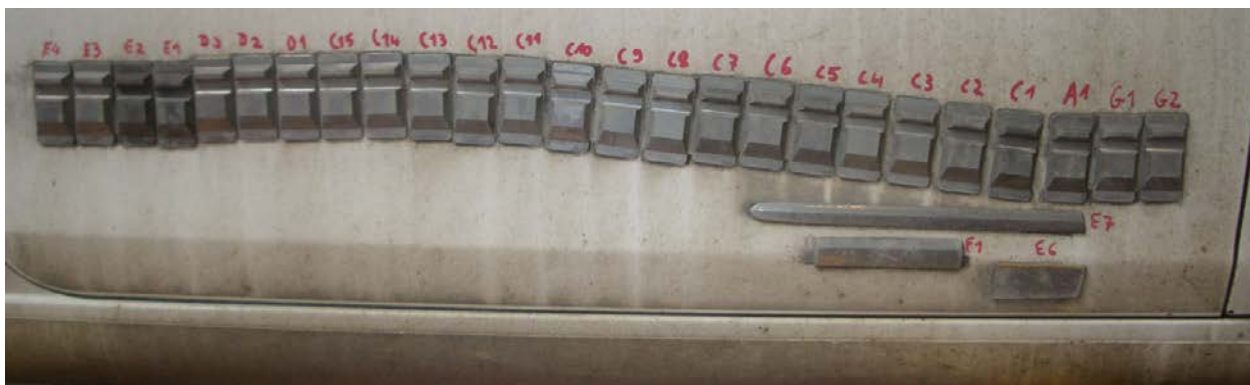
Abb. 89: Beispiel Testteilanordnung Feldversuch an der Fahrertür eines Versuchsfahrzeuges
