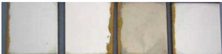
Abb. 90: Bauteilproben nach NaCl Belastung, Demontage und Reinigung
