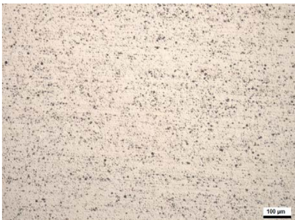
Abb. 72: Auflichtmikroskopische Aufnahme NiW 29,5 % nach E_R (40 min) und SPK (0,2 mV/s) bis E = 646 \text{ mV}_{(\text{NHE})} 6 M \text{CaCl}_2 , Oberfläche: NiW 29,5 % [25]
