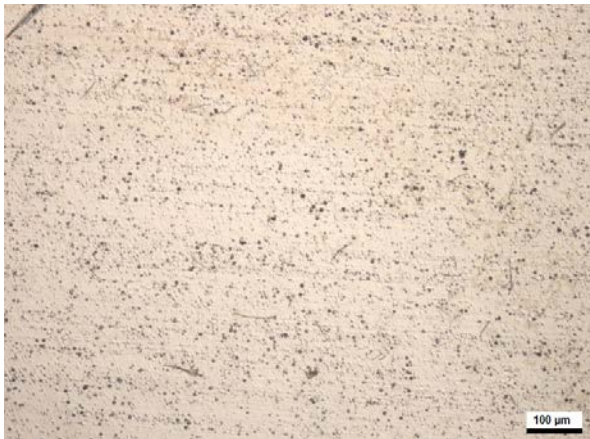
Abb. 70: Auflichtmikroskopische Aufnahme NiW 29,5 % nach E_R (40 min) und SPK (0,2 mV/s) bis E = 567 \text{ mV}_{(\text{NHE})} 4 M NaCl, Oberfläche: NiW 29,5 % [25]
