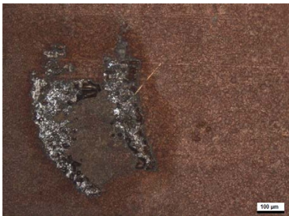
Abb. 55: Auflichtmikroskopaufnahme Glanznickel E_R (40 min), SPK (0,2 mV/s) bis E = 567 \text{ mV}_{(\text{NHE})} 4 M NaCl, Oberfläche: HG Ni/Cu [25]
