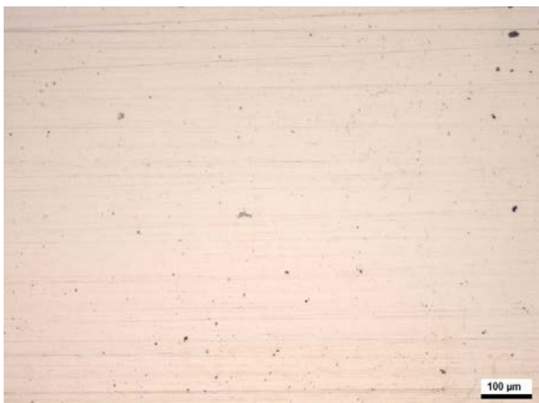
Abb. 85: Auflichtmikroskopaufnahme SnNi (A) nach E_R (40 min) und SPK (0,2 mV/s) bis E = 706 \text{ mV}_{(\text{NHE})} 5 M \text{MgCl}_2 , Oberfläche: SnNi (A) [25]
