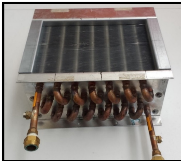
Abb. 6.1: Foto des handelsüblichen Wärmeübertragers
