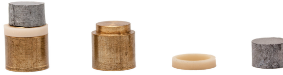
Abbildung 3.1: Von links nach rechts: Unverbundenes Diffusionspaar mit allen Einzelkomponenten, Diffusionspartner aus \alpha -Phase mit abgedrehtem Bereich, Keramikring und Diffusionspartner aus \varepsilon -Phase.
