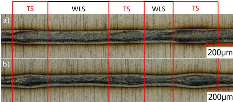
Abbildung 52: Wechsel von Wärmeleitungs- und Tiefschweißen (WLS und TS) an korrespondierenden Nahtoberseiten und Nahtwurzeln. a) Nahtoberseite, b) Nahtwurzel mit  $d_f = 78 \mu\text{m}$ ,  $s = 50 \mu\text{m}$ ,  $P = 112 \text{ W}$ ,  $v = 700 \text{ mm/s}$
