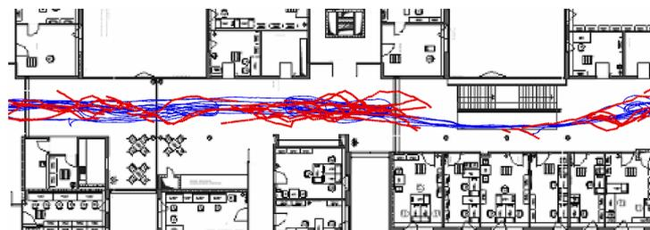
**Abbildung 6.4. Roboter- und Personentrajektorien:** Visualisierung der Trajektorie des Roboters (blau) und der durch den Roboter getrackten Trajektorien der Personen (rot) innerhalb des Hauptflures der Einsatzumgebung. Die getrackten Personenpositionen werden zum on-line Training und zur Evaluation des lernenden Prädiktionsverfahrens genutzt.
