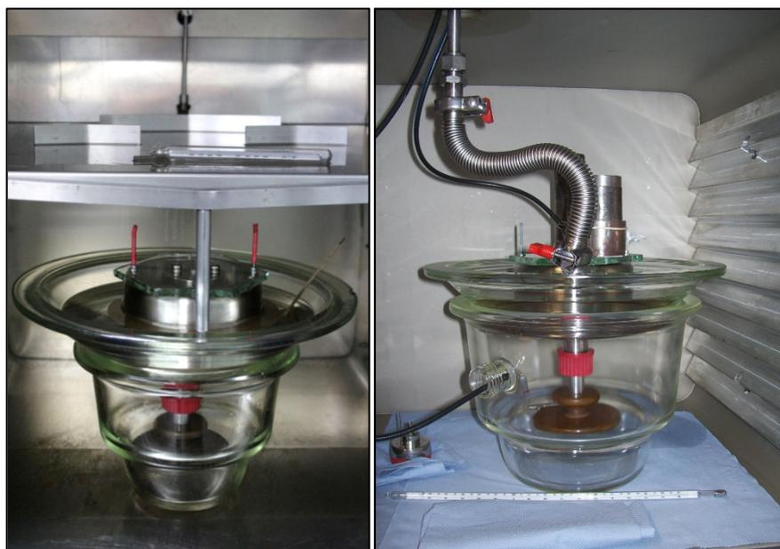
Abbildung 4.1-5: links: Ölaufbereitung (Trocknung und Entgasung) und direkte Befüllung der Messzelle für die Versuchszelle (1), rechts: Befüllung der Messzelle mit aufbereitetem Öl für die Versuchszelle (2)
