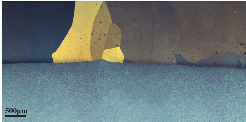
Abbildung 6.4: Phasenübergang im Gefüge nach Erstarren von \theta auf \alpha durch Cu-Zugabe zur Schmelze und Wiederaufschmelzen des eutektischen Übergangsbereiches. Die Phasen durchdringen einander nicht.
