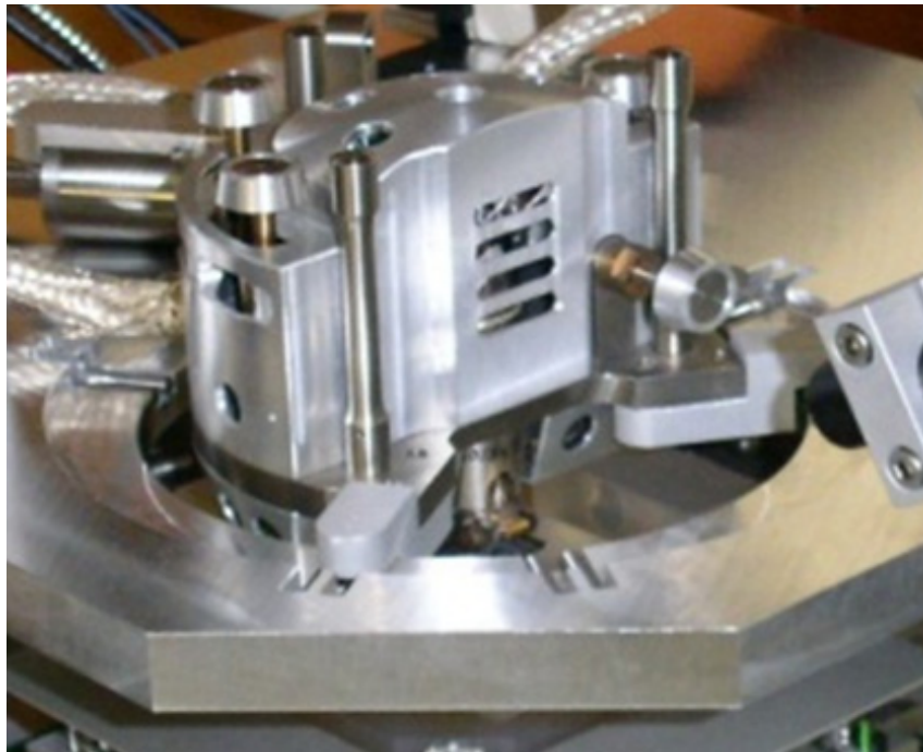
Abbildung 20: AFM-Sensor HV-2 von ND-MDT an einer NMM-1
