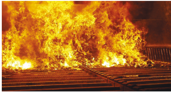
Abbildung 1.1. – Verbrennung von Müll auf dem Vorschubrost einer Müllverbrennungsanlage. Quelle: [Poulsen, 2007]
