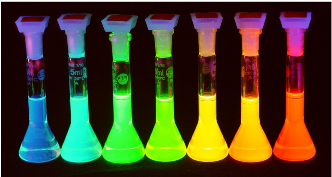
Abb. 1.1: Kolloidale CdSe-Nanopartikel zeigen unter UV-Anregung eine größenabhängige Fluoreszenzemission. [Foto: Arbeitsgruppe Prof. Weller, Uni Hamburg]
