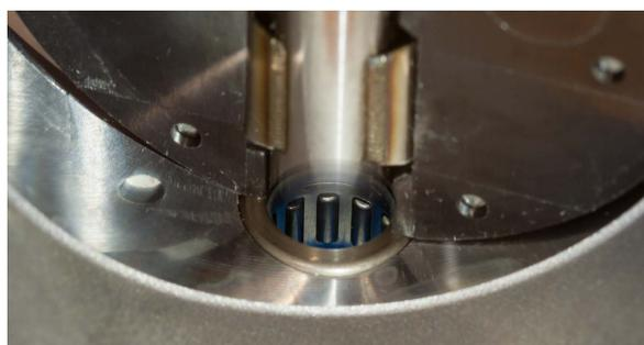
**Abbildung 2.2:** Lagerung der Klappenmechanik
