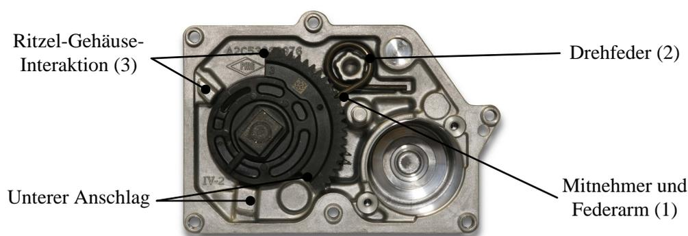
**Abbildung 2.6:** Anschläge der DRK
