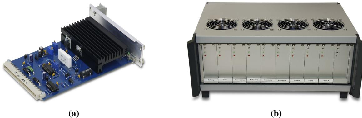
**Abbildung 4.3:** (a) Leistungselektronik (b) Gehäuse für die Verstärkerkarten
