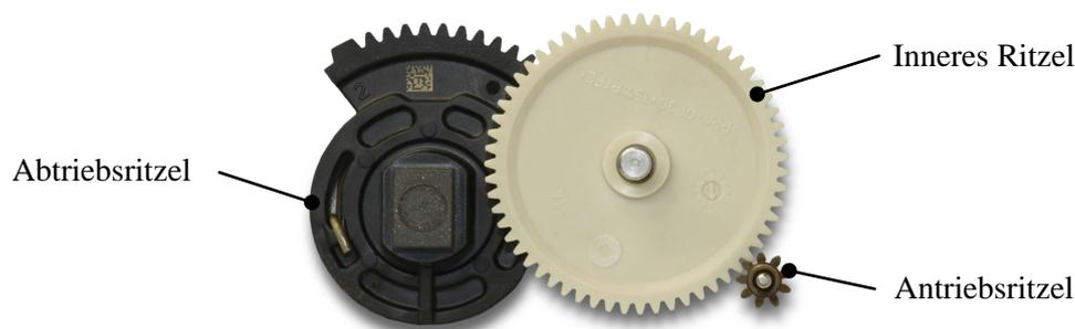
Abbildung 2.5: Getriebe der DRK
