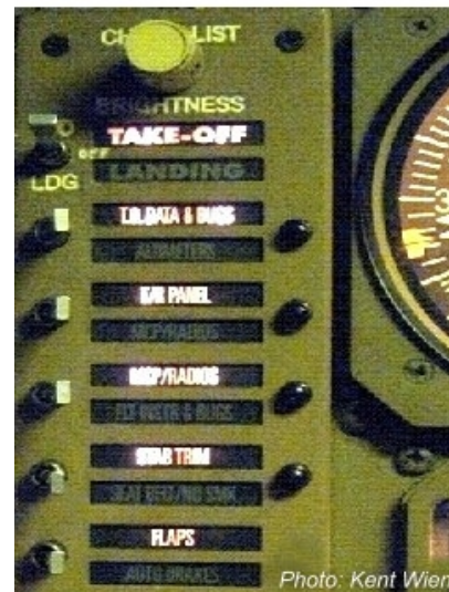
Abbildung 4.4: Teil einer MCL ( Take-Off ) in einer Boeing 757 .
