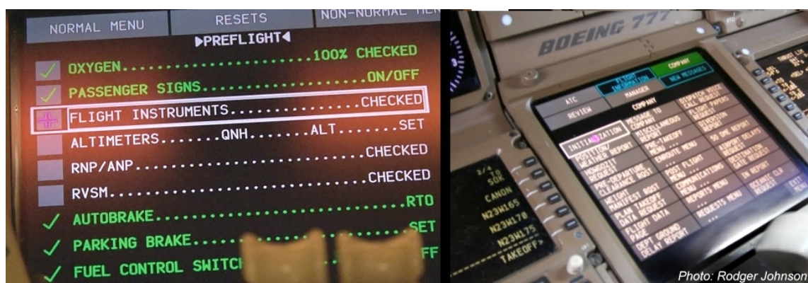
Abbildung 4.5: Elektronische Checkliste im Cockpit einer Boeing 777 .
