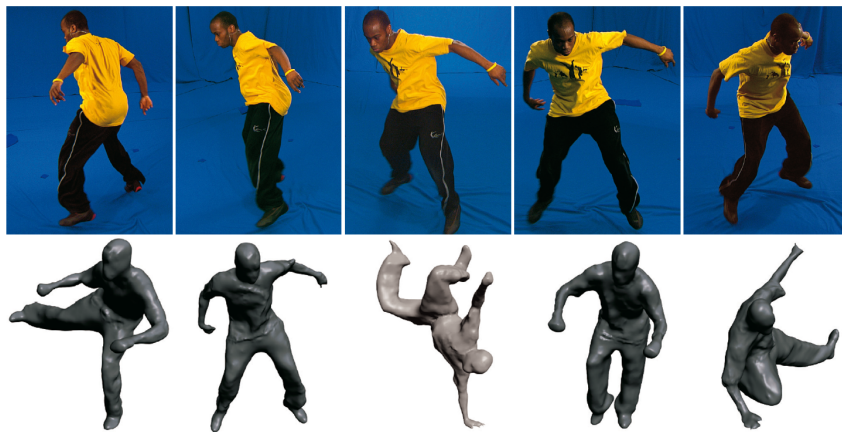
Abbildung 2.27.: Teil des Eingangsdatensets und mittels verfeinertem Shape-from-Silhouette Algorithmus erzeugte Ansichten des 3D-Modells. Aus [Starck und Hilton, 2007].
