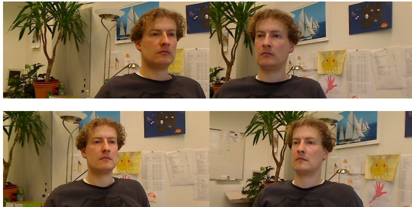
Abbildung 4.5.: Ausschnitte aus Stereo-Beispielaufnahme mit großem Basisabstand. Oben wird eine achsenparallele Anordnung genutzt. Verdeckungen und großer Disparitätsbereich sind klar erkennbar. Der Disparitätsbereich kann durch eine konvergente Anordnung reduziert werden. Die Verdeckungsproblematik bleibt bestehen. Bei beiden Aufnahmen hatten die Kameras einen Abstand von ca. 34 cm und die Person saß ca. 75 cm entfernt. Dies entspricht dem Abstand bei heute gängigen 19"-Monitoren mit normalem Betrachtungsabstand.
