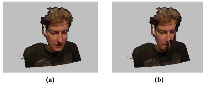
Abbildung 5.21.: (a) Korrekte Tiefensortierung durch Aktivierung des Tiefenpuffers der Grafikkarte. (b) Bei deaktiviertem Tiefenpuffer können je nach Position der virtuellen Kamera Artefakte wie im Bild entstehen.
