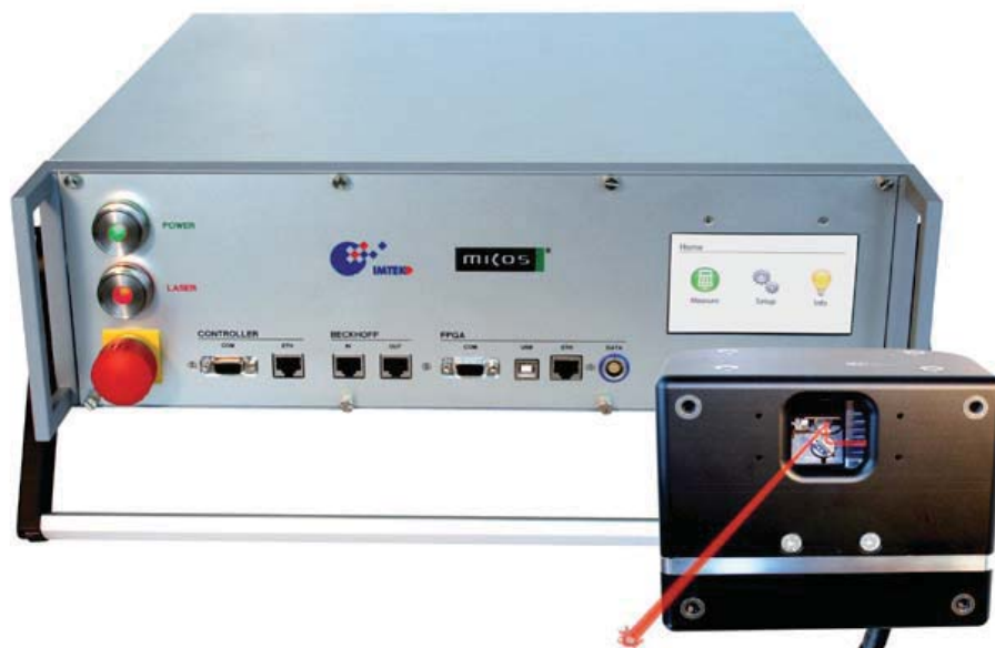
Abbildung 2.8: Lasertracker-System der Firma PI miCos sowie deren Signalverarbeitungselektronik [73]
