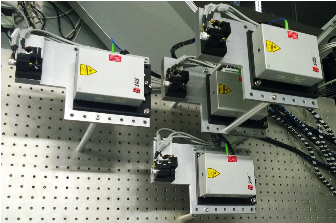
Abbildung 9.7: Die Aufstellung der Trackermodule für die Kalibrierung des MLTS
