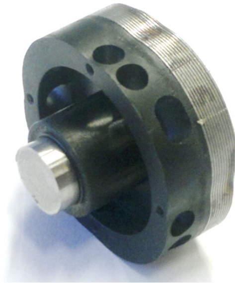
Abbildung 47: Erscheinungsbild des radialen Materialabtrags an Polyamid
