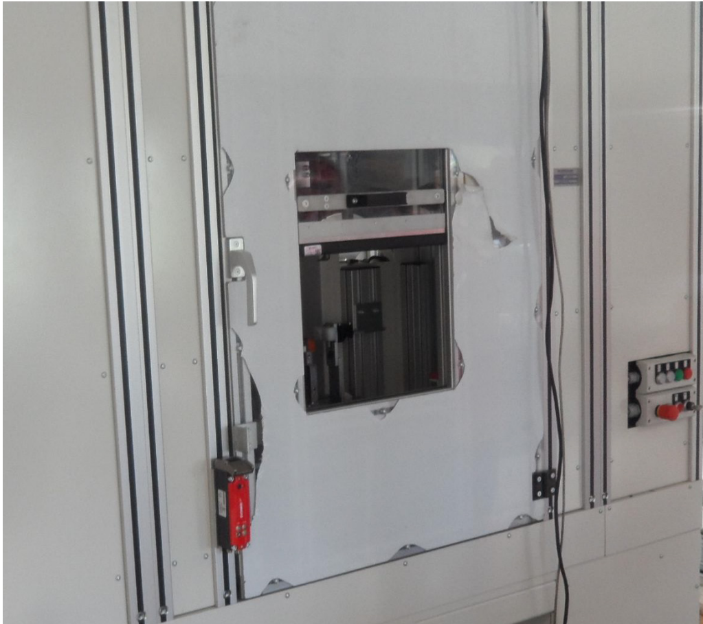
Abbildung 24: Schutztür der Wuchtstation
