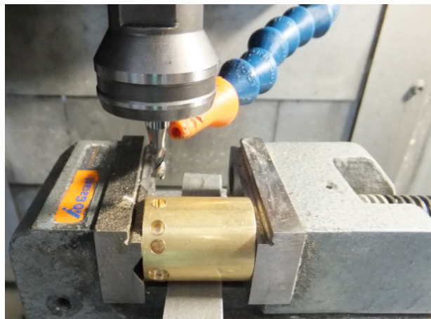
Abbildung 28: Probenhandhabung zur Durchführung der Abtragversuche
