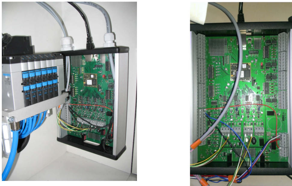
Abbildung 26: Schnittstelle zwischen analogem Messsignal und PC per TCP/IP
