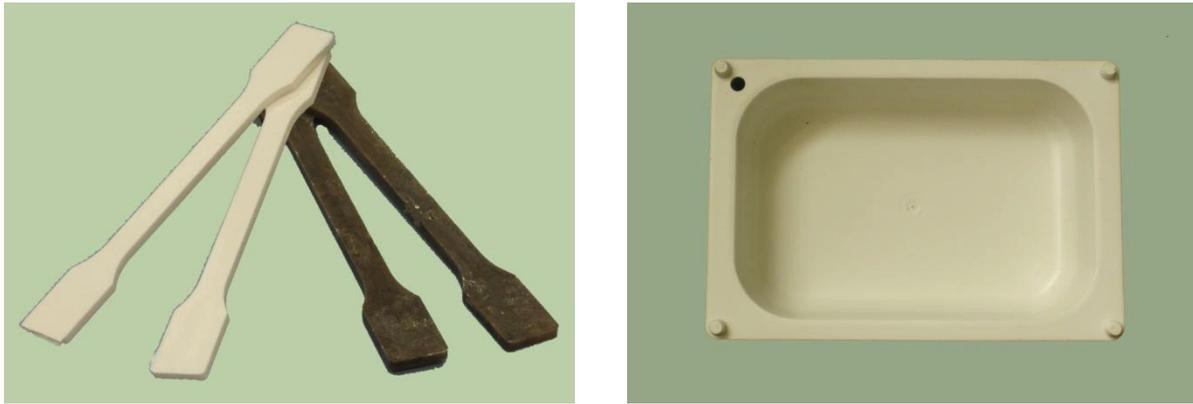
Abb. 15: Gehäuse (rechts) und Schulterstäbe (links) aus biobasierten Polymercompounds
