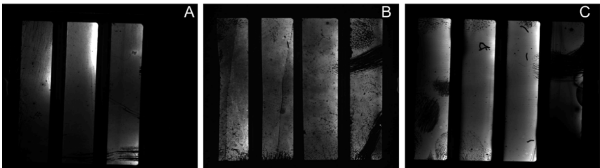
Abbildung 9-9: ELI-Aufnahmen unterschiedlicher Solarmodule bei 4 Volt Vorwärtsspannung A: Solarmodul auf ITO-Glas, B: Solarmodule auf ITO-PET, C: Solarmodul auf PH1000-PET.
