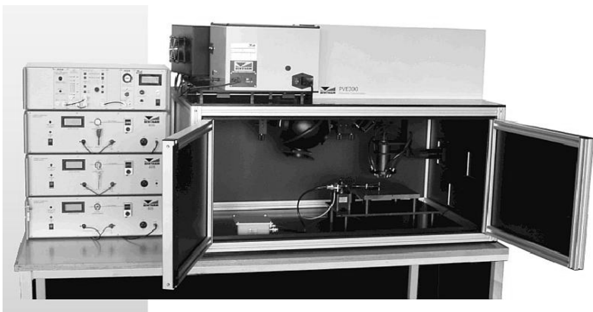
Abbildung 5-8: EQE-Messplatz PVE300 „Bentham PVE300 Photovoltaic Spectral Response Characterisation System“ [130]
