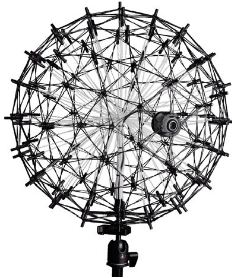
Abbildung 3.15: Beispielhaftes offenes Kugelarray mit 120 Mikrofonen und einem Durchmesser von 60 cm [Gfai Tech GmbH, 2013].
