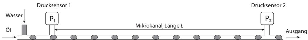
**Abbildung 2.10:** Prinzip zur Messung des Druckabfalls von Zweiphasenströmungen mittels Drucksensoren. Der Druckabfall wird über ein Kapillar- oder Mikrokanalsegment der Länge  $L$  aus der Differenz der Drucksensorwerte  $\Delta p = p_1 - p_2$  ermittelt. Das Kanalsegment besitzt eine konstante Querschnittsfläche und definierte Benetzungseigenschaften. Die Gesamtflussrate und das Volumenverhältnis der Zweiphasenströmung wird z.B. über Spritzenpumpen eingestellt.
