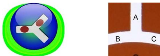
**Abbildung 5.6:** Bifurkation als Symbol der mikrofluidischen Operationseinheit und als Struktur im Chip
