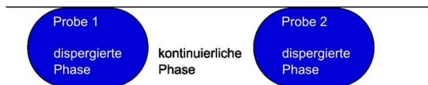
**Abbildung 2.1:** Symbolische Darstellung der Flüssig/flüssig Zweiphasenströmung im Mikrokanal
