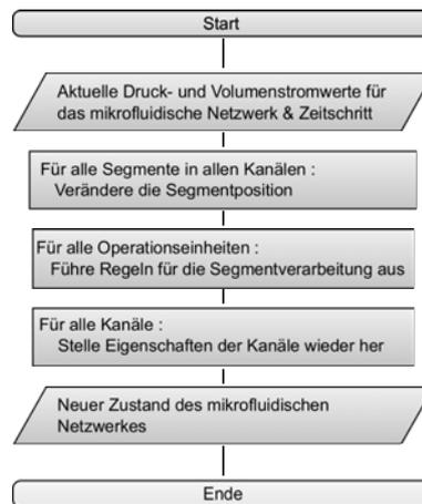
**Abbildung 4.36:** Algorithmus zur Berechnung der Prozessierung der Segmente durch das mikrofluidische Netzwerk
