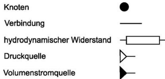
Abbildung 4.11: Objekte des Simulationsnetzwerkes
