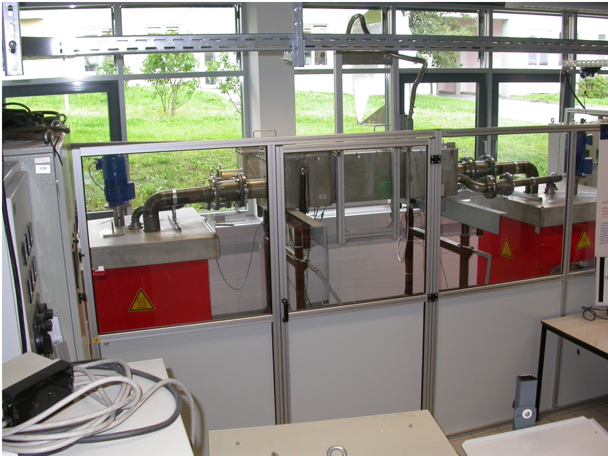
Abbildung 18: Die Flüssigzinnkalibrieranlage LiTinCa ohne Lorentzkraft-Anemometer. Am linken Bildrand befindet sich der Schmelzofen inklusive der Flüssigmetallpumpe. Das flüssige Zinn wird über die Rohrleitungen durch die Kompensatoren hindurch in den Kalibrierkanal geleitet. Der Kalibrierkanal kann mit Hilfe von elektrischen Hubgetrieben beliebig zwischen 0 und 5° geneigt werden. Der Pegel im Kalibrierkanal wird durch die in der Testsektion in der Mitte angebrachte Pegelmesseinrichtung gemessen. Die Schmelze wird im Auffangbehälter am rechten Bildrand gesammelt und anschließend durch den Kalibrierkanal zurückgepumpt.
