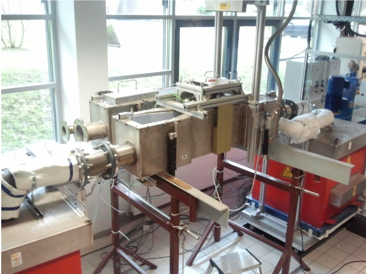
Abbildung 19: Die Flüssigzinnkalibrieranlage LiTinCa gegen Ende der Versuche. Im Bild ist deutlich das am Referenzkanal angebrachte Lorentzkraft-Anemometer sowie die Hubgetriebe und die Pegelmess-einrichtung zu erkennen. Die dünnen Rohre der Pumpen mussten zusätzlich mit entsprechenden Rohr-begleitheizungen versehen werden.
