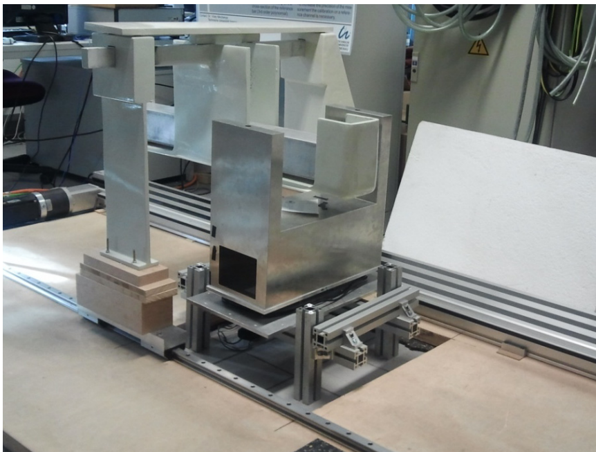
Abbildung 14: Neubau des Versuchsaufbaus zur trockenen Kalibrierung. Das Lorentzkraft-Anemometer steht nun auf dem Laborboden. Die Metallproben werden durch das Gerät bewegt. Die Probenaufnahme wurde aus glasfaserverstärktem Kunststoff gefertigt.
