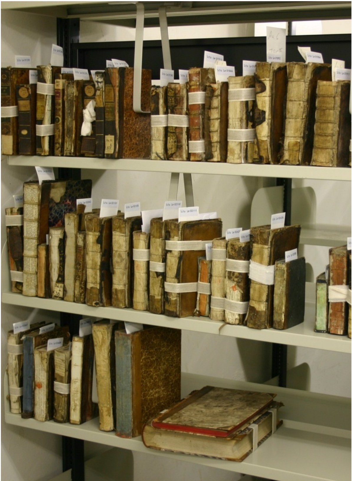
Abbildung 14: Brandgeschädigte Leder- und Halbledereinbände. Bedingt durch die Aufstellung im Regal sind besonders die exponierten Rücken geschädigt. Die hier verwendeten Mappenbänder mit Klettverschluss wurden kurze Zeit später gegen solche mit Kordelzug ausgetauscht, da die Gefahr bestand, dass sich die Klettverschlüsse lösen und mit dem Originalmaterial verbinden. Foto: KSW/HAAB
