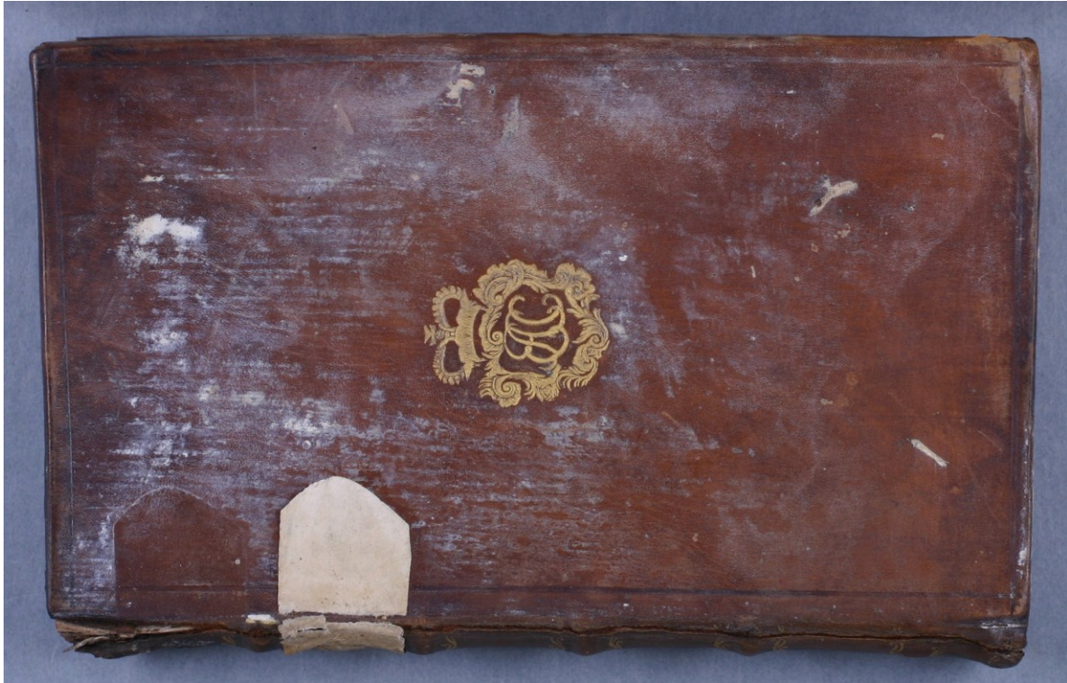
Abbildung 8: Ein brandgeschädigter Ledereinband mit Verschmutzungen, verkrustetem Löschschaum, Deformierungen und aufgeplatzten Fälzen. Das Buch stammt aus der Privatbibliothek von Herzog Ernst August Constantin von Sachsen Weimar Eisenach (1737–1758), wie das Supralibros zeigt. Viele Bücher aus ehemals herzoglichem Besitz zählen zu den Brandschäden und –verlusten. Foto: KSW/HAAB
