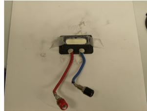
a) mit Sandstrahlen homogen erblindetes Kleinmodul
