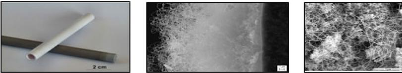
**Abb. 1a-c:** Zustand der Trägermembranen vor der Bekeimung (a), CNT-Wachstum auf der Außenseite einer mit HCl modifizierten  $ZrO_2$  Schicht (b), CNT-Wachstum unter Modifikation von Prozessparametern auf  $ZrO_2$  (c).
