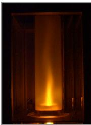
**Abb. 2:** Fackel eines induktiv gekoppelten Plasmas. Infolge des tangentialen Gasstromes hat diese eine spiral-artige Charakteristik.
