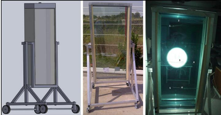
**BILD 2: VERSUCHSSTAND DER DOPPELSCHALIGEN FASSADE IM MODELL (A) IM FREIEN (B) IM LABOR (C) (A+B [3])**
