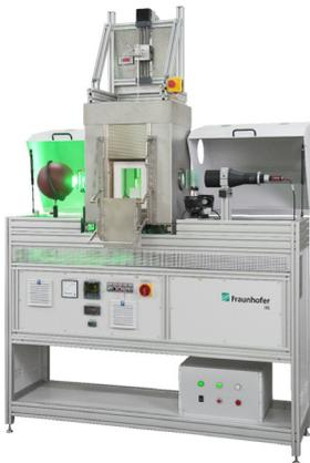
**Bild 3:** TOMAir – Thermo-Optisches Messverfahren für oxidische Anwendungen
