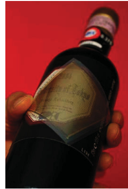
Abb. 38: links - Aufbau eines gewölbten Scanners durch Kombination OFET und PSC, rechts - Anpassung an Oberflächen möglich
