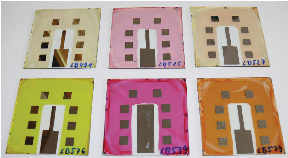
Abb. 31: Foto von PSC (Bed. s. Tab A11 - Anhang ): links ohne Sensibilisator, Mitte mit LIN06 und rechts mit DCM
