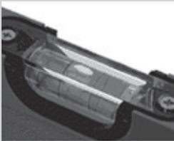
Die Libelle befindet sich genau zwischen der Begrenzungsanzeige. Die *Messgenauigkeit* ist auf der Wasserwaage meist in Millimeter pro Meter angegeben und wird von einem amtlichen *Prüfamt per Siegel* bestätigt. Das nennt man auch *Eichung*.
