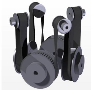
Bild 17 : Realisierung gekreuzter Achsen durch Halbierung der Schränkung.
