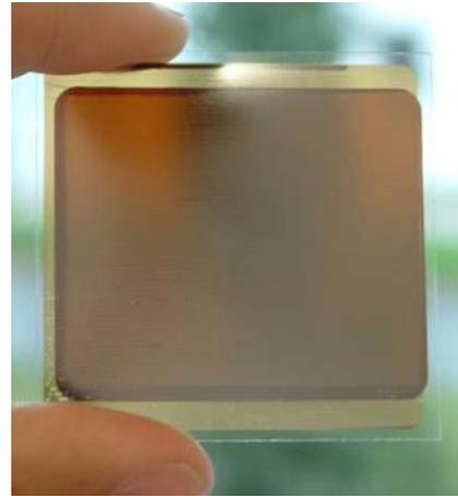
Abb. 15. Keimschicht auf Glas ( $10 \times 10 \text{ cm}^2$ ) und Dünnschicht-Solarzelle auf Glas ( $5 \times 5 \text{ cm}^2$ )
