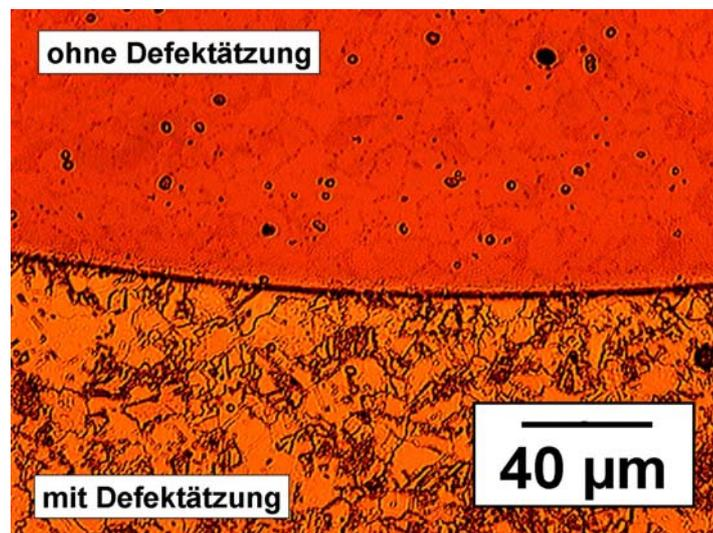
Abb. 57. Schichtweise Laserkristallisation auf Aluminium-induzierter Keimschicht mit Zwischenschicht
