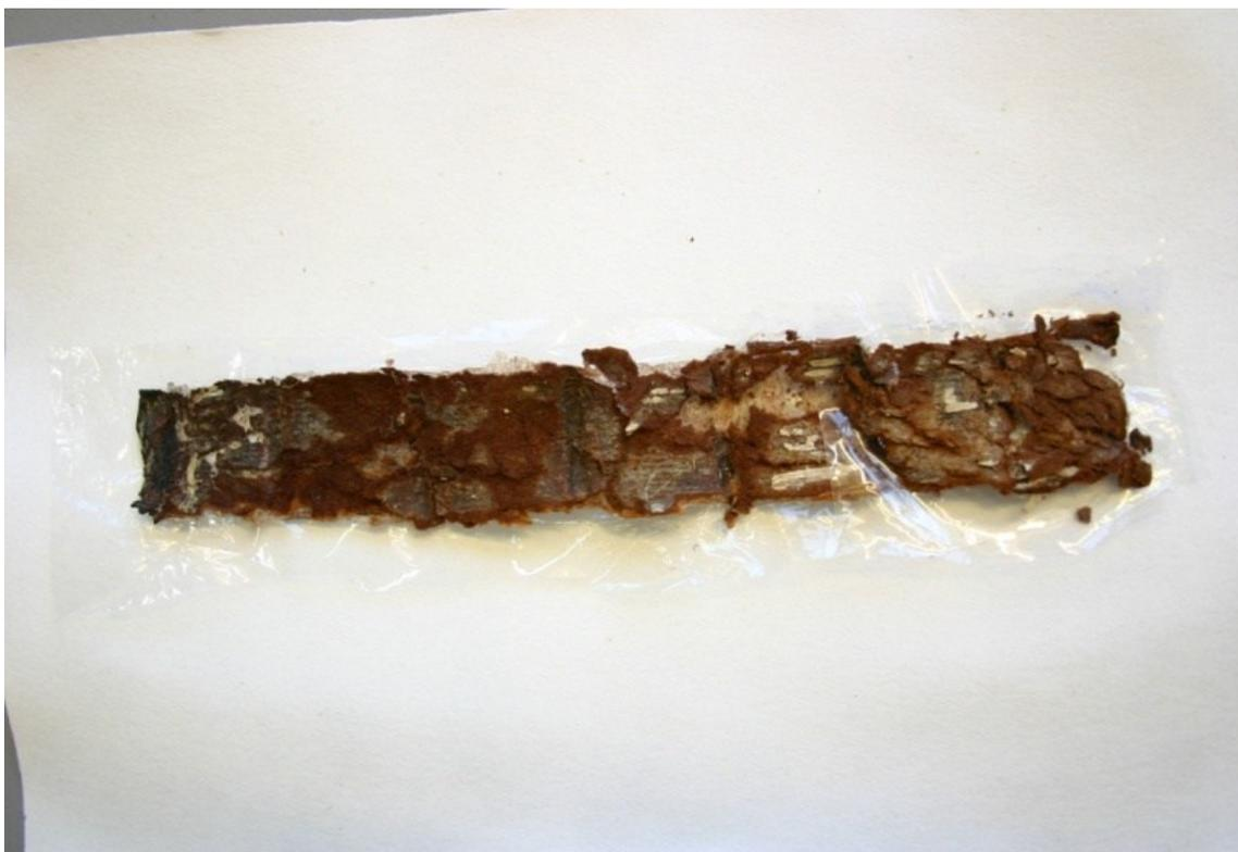
**Abbildung 11:** Trotz stabilen Trägermaterials gelingt nicht immer eine zerstörungsfreie Abnahme. Foto: KSW/HAAB
