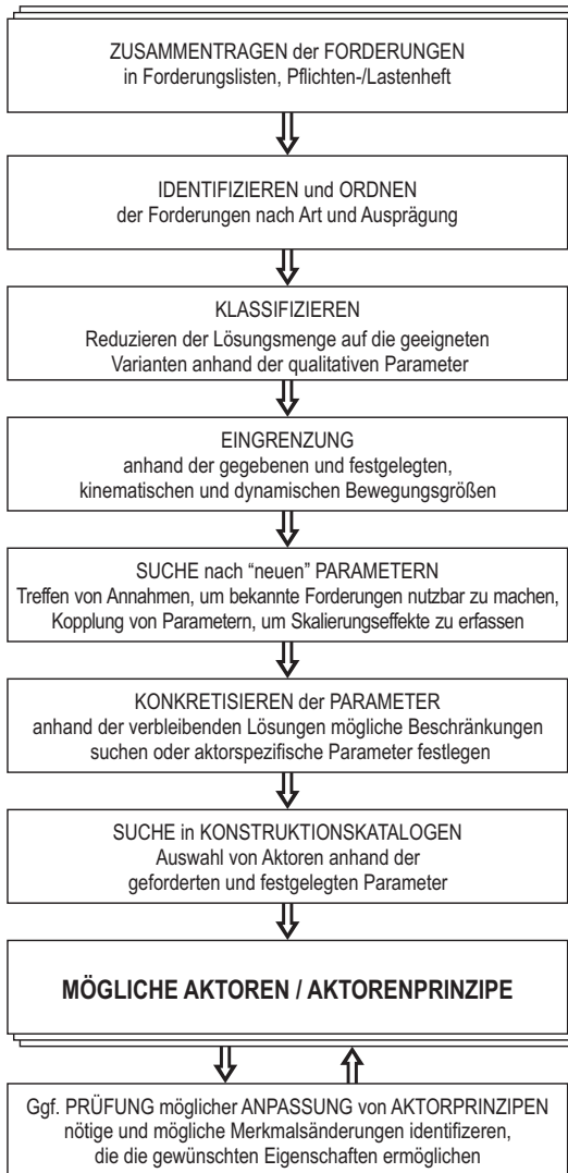
Abbildung 4.3: Nutzung und Konkretisierung verschiedener Parameter bei der Aktor- und Aktorprinzipauswahl. Iterationsschleifen zwischen den einzelnen Schritten sind möglich.
