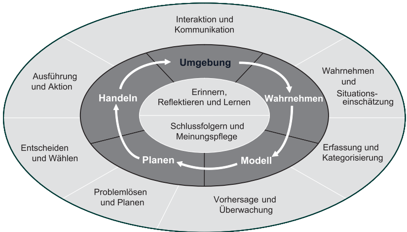
Abbildung 2.1.: Erweiterter Wahrnehmungs-Handlungs-Zyklus im Rahmen von kognitiven Architekturen. Der mittlere Ring stellt dabei den grundlegenden Wahrnehmungs-Handlungs-Zyklus dar. Die Umwelt wird mittels wie auch immer gearteter Sensorik wahrgenommen. Diese Beobachtungen werden dann zum Planen genutzt, wozu ein Modell zum Einsatz kommen kann. Basierend auf dem Plan wird eine Handlung ausgeführt, die die Umgebung beeinflusst. Dies wird wieder beobachtet und der Zyklus beginnt von neuem. Der äußere Ring hingegen beschreibt detaillierter die Aufgaben, die sich für eine kognitive Architektur direkt aus diesem Zyklus ergeben. Der Kern der Darstellung beschreibt Aufgaben, die nur indirekt auf den Wahrnehmungs-Handlungs-Zyklus abbildbar sind, sondern es wird das interne Wissensmanagement der Architektur beschreiben.
